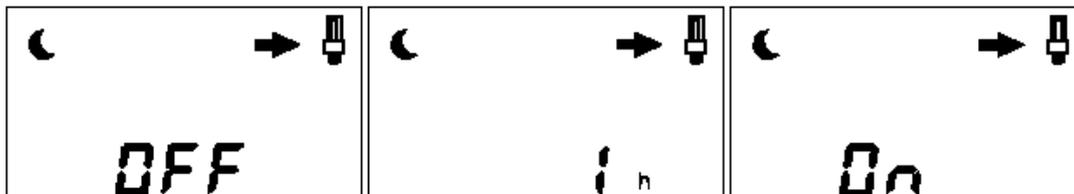
Esta función activa la salida de carga sólo cuando está oscuro (de noche). Cuando está claro (de día) la salida de energía hacia la carga permanece desactivada. La información sobre la claridad se obtiene a través del módulo solar instalado. En cuanto el regulador recibe la información del módulo solar de que está oscuro, éste conecta la corriente de trabajo.
