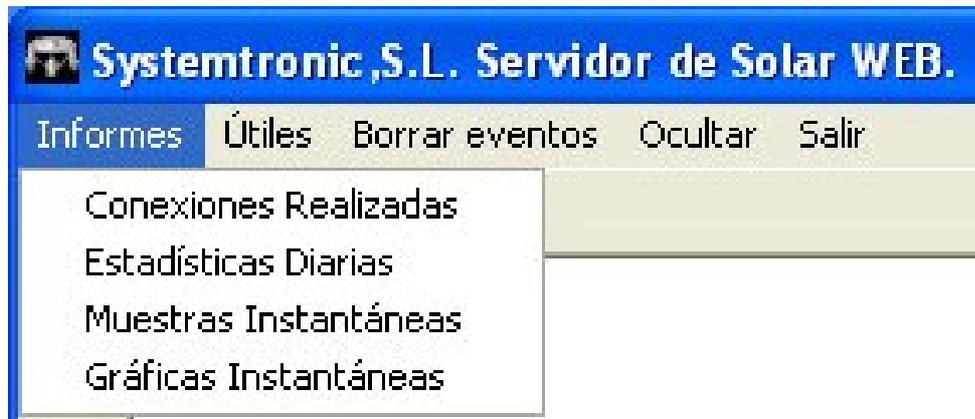
Las opciones del menú **informes** ejecutan un programa que funciona sin conexión con el entrenador. Por lo tanto, la información que proporciona procede de un fichero que se alimenta con los datos descargados cuando hay conexión, según se describe en el apartado 3.2.2.
