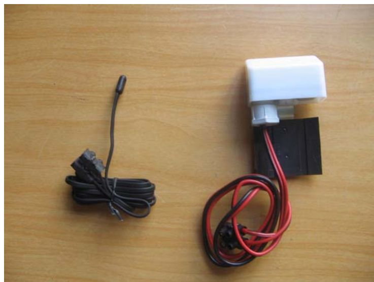
Fig. 4.4. Sensor de temperatura (izquierda) y de irradiación solar (derecha)
