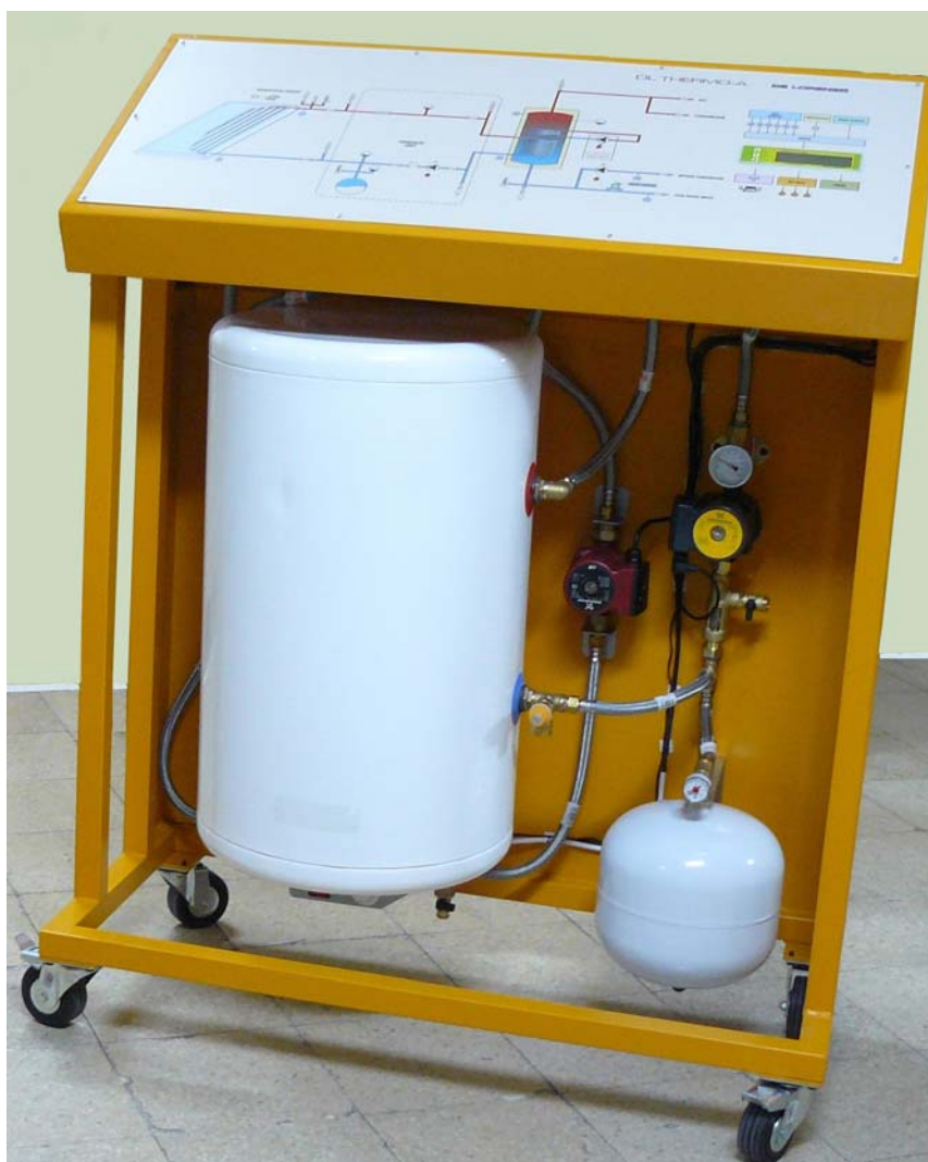
Fig. 1.1. Colector solar y consola de control y almacenamiento. El colector puede ser uno comercial o bien el simulador.
