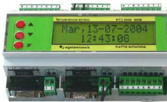
Fig. 3.3. Central electrónica de control
