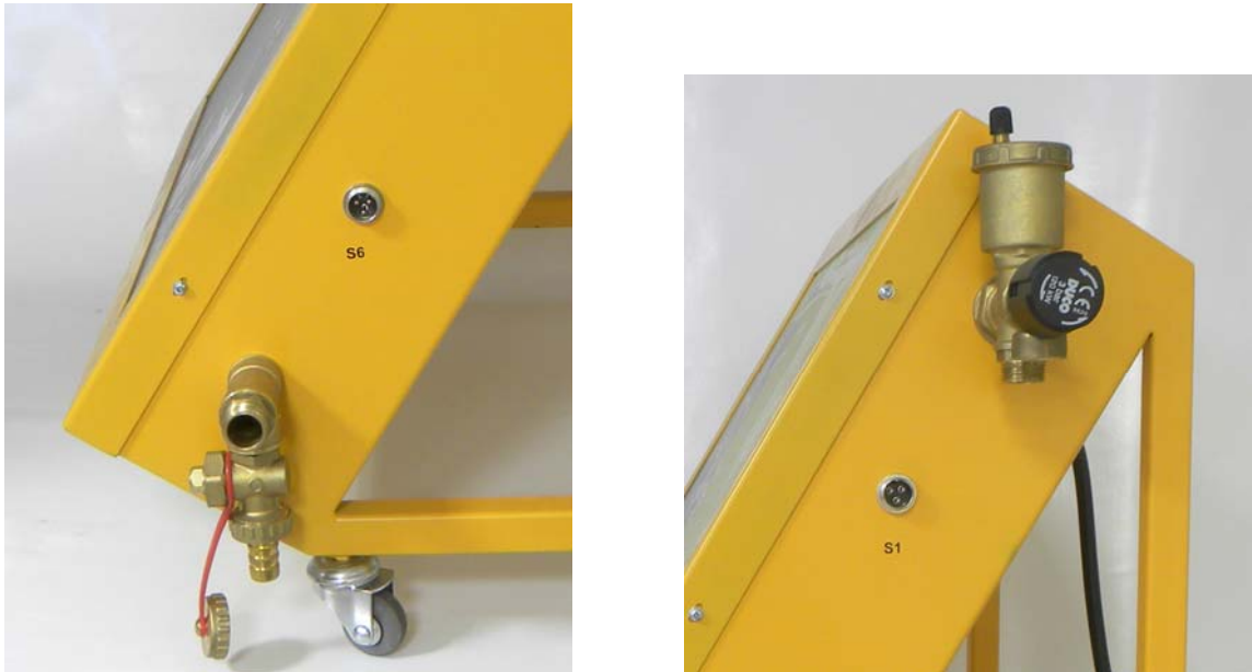
Fig. 4.3 b) Conexiones hidráulicas del simulador del panel solar
