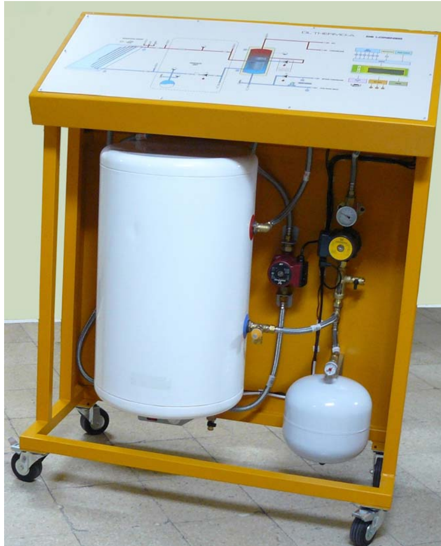
Fig. 2.4. Consola de control y almacenamiento de ACS.
