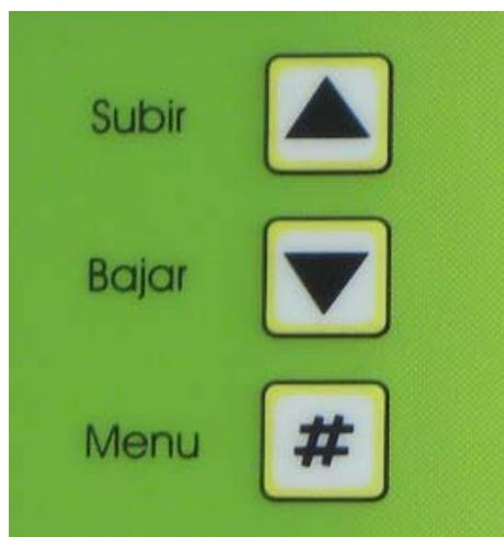
Las teclas de subir y bajar permite el desplazamiento por el menú y la # para validar la función deseada.
