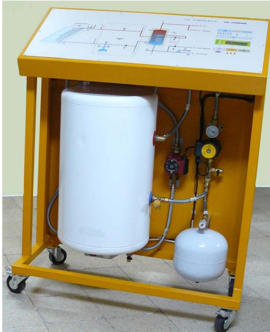
Fig. 2.4. Consola de control y almacenamiento de ACS.
