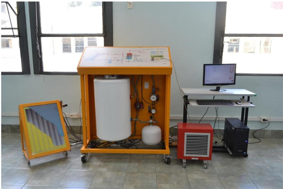
Entrenador modular de energía solar térmica apoyado por PC
