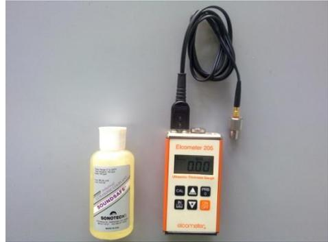
Medidor ultrasónico de espesor
