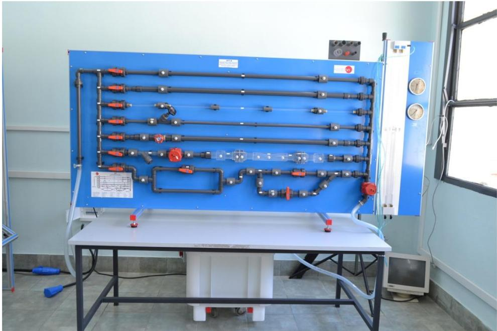
Equipo de fricción en tuberías con grupo de alimentación hidráulica
