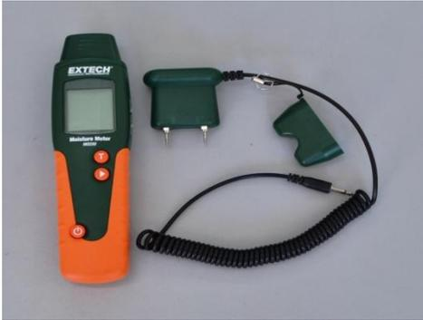
Medidor de humedad en maderas
