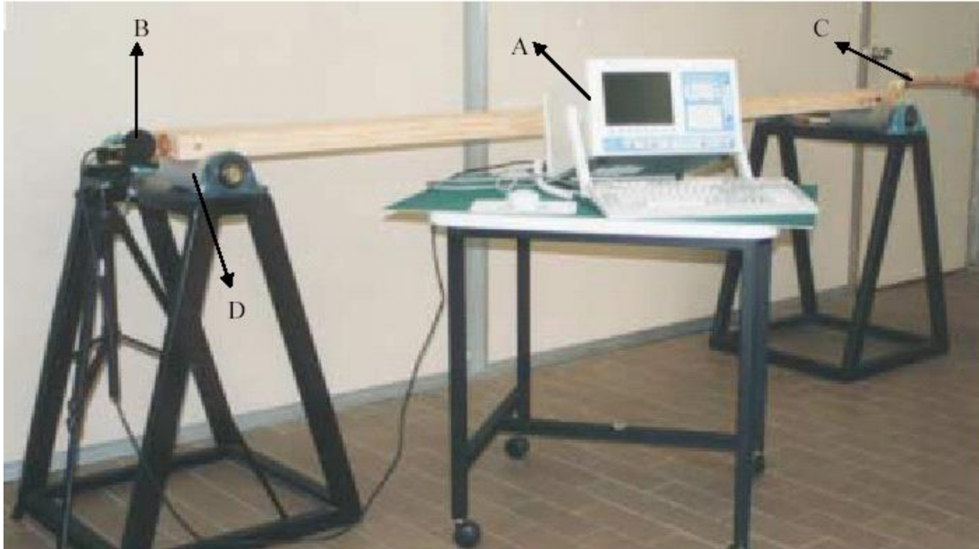
Foto N°2. Donde: A⇒ FFT Analyzer; B⇒ Micrófono; C⇒ Martillo, D⇒ Poliuretano
